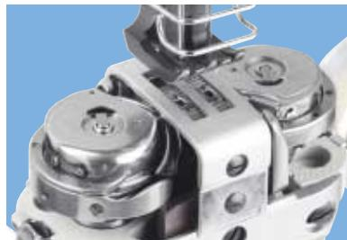
Při šití silnými nitěmi zajišťují velkoprůměrové chapače dostatečnou zásobu spodních niti. Stroj se standardně dodává s rozpicem jehel 8 mm. Na objednávku lze dodat i rozpic 10 a 12 mm.
